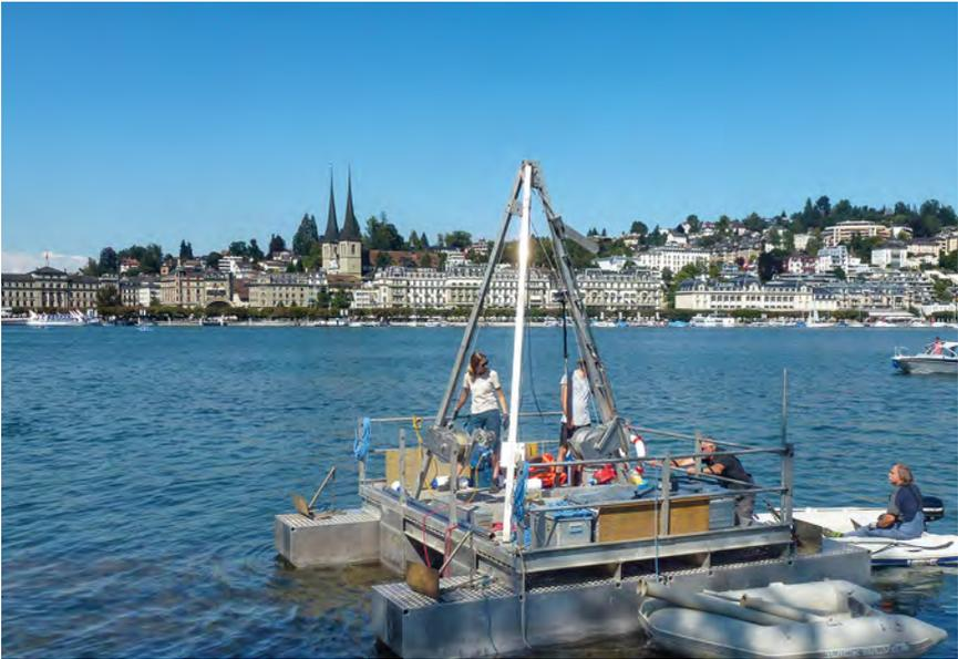
Plattform der Uni Bern zur Entnahme von Bohrkernen
