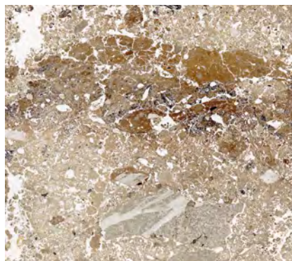
... Stabilisierung der Probe mit Gipsbinden, Anschliff nach der Durchtränkung mit Kunstharz mit Markierungen der für einen Dünnschliff gewählten Ausschnitte, Dünnschliff des zweiten Ausschnitts von oben*
