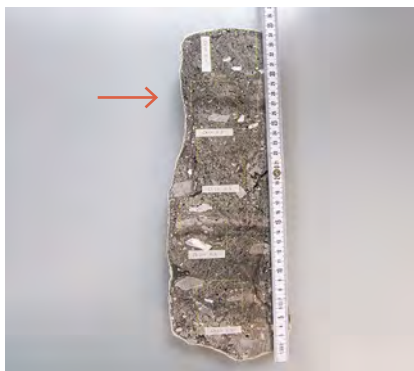
... Stabilisierung der Probe mit Gipsbinden, Anschliff nach der Durchtränkung mit Kunstharz mit Markierungen der für einen Dünnschliff gewählten Ausschnitte, Dünnschliff des zweiten Ausschnitts von oben*
